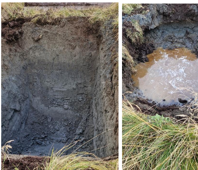
Bilde 1 - Prøvehull 1 før grunnvannet trengte inn i prøvevegropa og etter ca 30 minutter.
