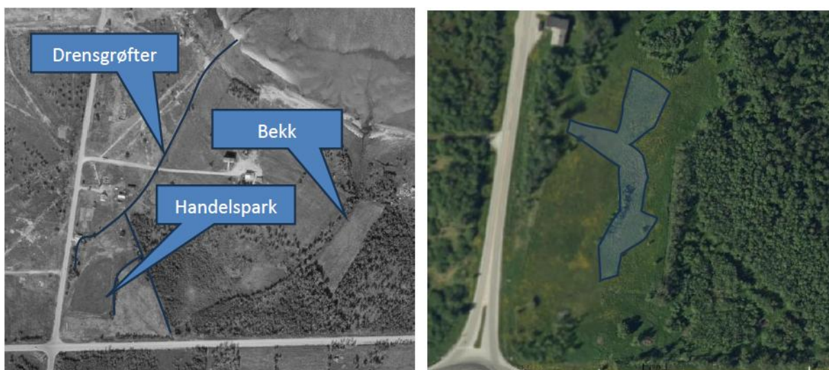
Figur 15: Til venstre oversikt over de største drengrøftene og til høyre området hvor grunnvannsstanden sto i «dagen» på befaringstidspunktet
